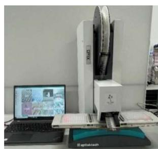
図 10 タンパク質結晶化用ナノリッター分注機 mosquito Xtal3 (SPT Labtech 社製) を用いた結晶化スクリーニング
